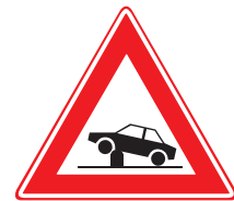
J39 Waarschuwing voor elektrische in- en uitschuifbare paal in de rijbaan (poller) waar- mee toegankelijkheid van straten en gebieden kan worden geregeld.
