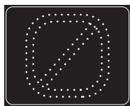
F9 Einde van alle op een elektronisch signaleringsbord aangegeven verboden en adviezen
